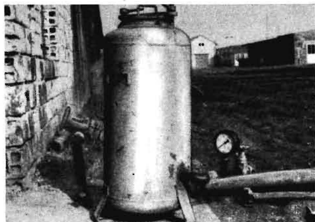
Bild 3. Druckseitig arbeitende Nährstoffverregnungsanlage, die von Sigma/Olomouc CSSR gefertigt wird
