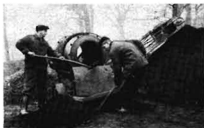
Bild 3 Das motorisierte Erdsieb bei manueller Beschickung
