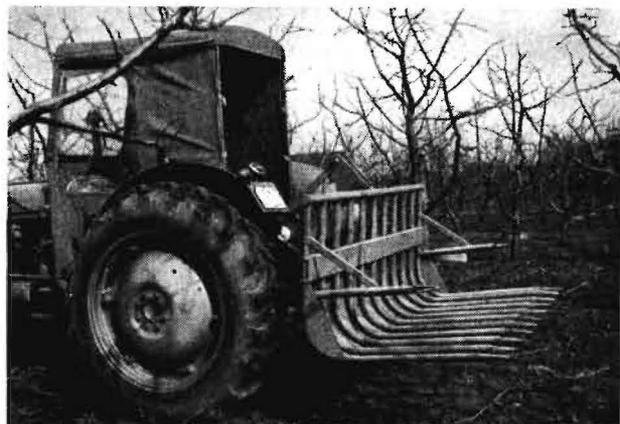
Bild 1. Schnittholzräumer am ITM-Schlepper in Transportstellung
