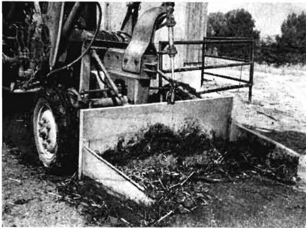
Bild 7. Schiebeschild mit seitlichen Führungsblechen, befestigt am Kastenträger des RS 09 (auch ohne Frontlader T 150 einzusetzen)
