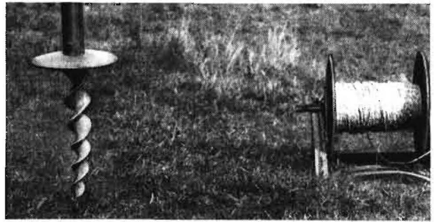
Bild 4. Haltepfahl mit bohrerförmigem Unterteil
