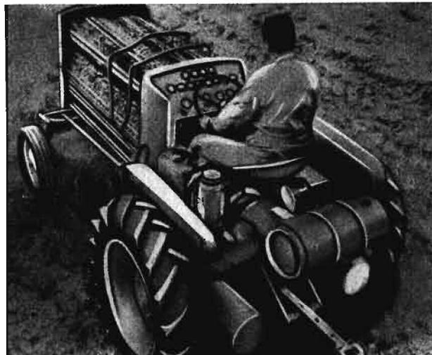
Bild 2. Versuchsschlepper mit Propangasbatterie (Kraftstoffbatterie) von Allis-Chalmers
