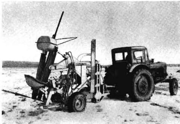
Bild 3. Die Maulwurfrohrdränmaschine bei der Arbeit
