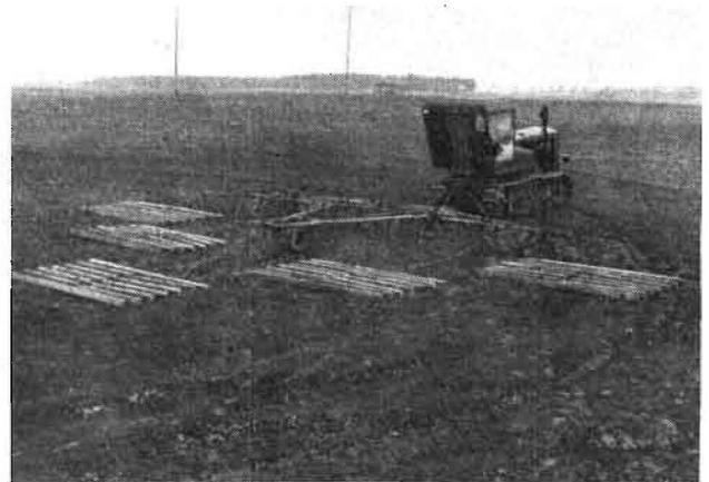
Bild 2. Der verbreiterte Kopplungsbalken Z 102 mit fünf Ackerschleppen
