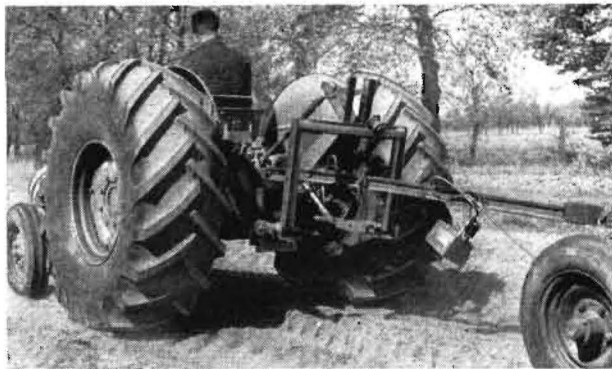
Bild 4. Versuchsschlepper mit großvolumiger Bereifung und Vorrichtung zur ALE bei Zugkraftmessungen
