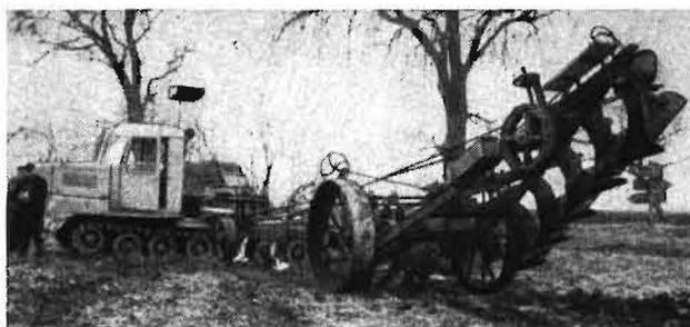
Bild 1. Seilzugaggregat SZ 241 mit Kipp-Pflug (Heucke-Pflug)
