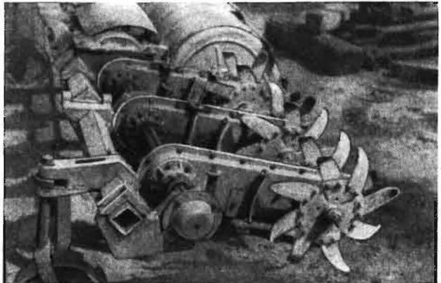
Bild 2. Werkzeugträger mit in Fahrrichtung rotierenden Hacksternen
