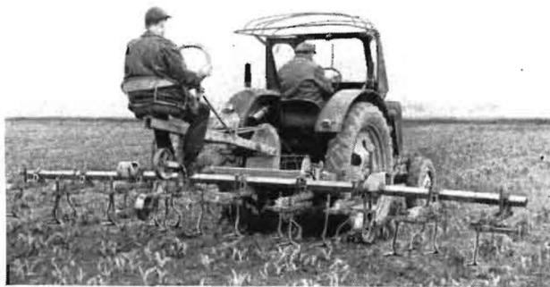
Bild 5. Dreipunkt-Heckanbau P 430 mit 5,0-m-Werkzeugträger
