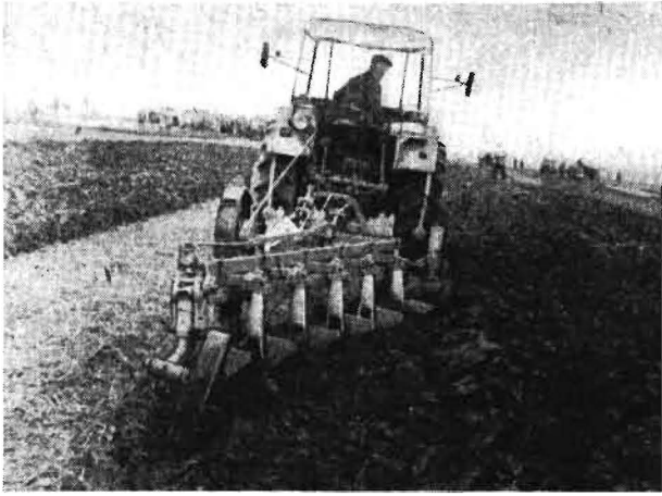
Bild 2. Gute Schälarbeit ist auf den schweren Böden mit dem DF 16 besonders wegen seiner schmalen (6-Zoll)-Körper möglich
