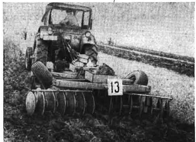
Bild 1. Die Scheibenegge eignet sich nicht zur Stoppelbearbeitung
