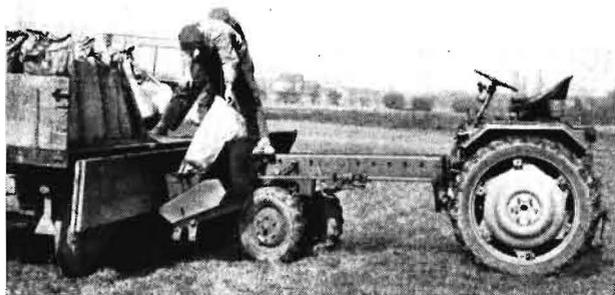
Bild 6. Dünger nachfüllen beim Großflächendüngerstreuer D 385 mit dem Lader T 170
