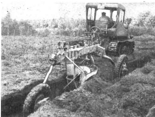
Bild 4. Anhängesandbodenmeliorationspflug B 175 bei der Arbeit
