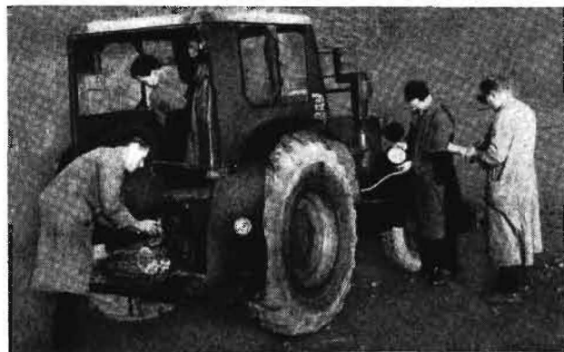
Bild 5. Öldruckmessung am Motor. Die Einregulierung einer bestimmten Motordrehzahl erfolgt mit Hilfe eines Stichtachometers über die hintere Zapfwelle
