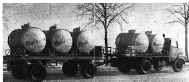
Bild 2. Tankzug S 4000-1 mit 4-t-Anhänger (10 000 l) (Foto: ICM)
