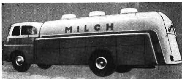
Bild 1. Milchtankfahrzeug (6500 l) aus Ungarn (Foto: Sonntag)
