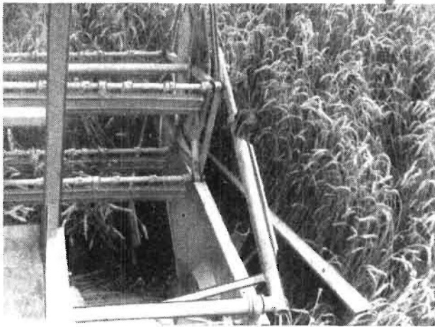
Bild 6. Halmteiler vergrößern die wirksame Schneidwerksbreite
