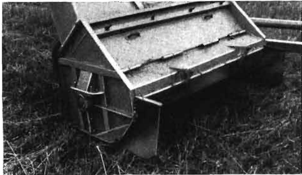
Bild 1. • Zusätzlich angebrachte Blechblenden am Trommelgehäuse des Schlegelernters verringern die Spritzverluste (Bild 1 und 2: Foto SEYFARTH)
