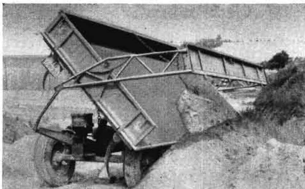
Bild 4. Traktorenanhänger TK 5 mit automatischer Bordwand System „Meißen“
