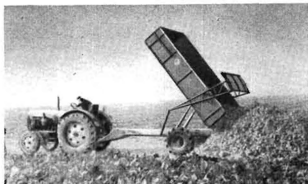
Bild 5. Kopflastiger Einachsanhänger (Hinterkipper) mit automatischer Bordwand (Versuchsfahrzeug)
