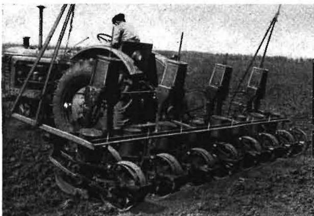
An den Legemaschinen ergeben sich seit Fortfall der Quadratnesteinrichtung erhebliche Masseinsparungen. Die sechsstreihige SKGN-6 wiegt 760 kg, die achtreihige SKPN-8 780 kg, also trotz größerer Anzahl Säaggregat mit gleichem Grundaufbau nur 20 kg mehr.
