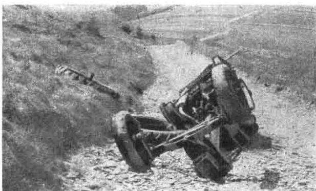
Bild 1. Folgeschwerer Traktorenumsturz bei Mahd im hängigen Gelände infolge Nichtbeachtung der erhöhten Unfallgefahren
