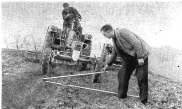
Bild 3. Genaue Bestimmung der Hangneigung ist notwendig, um die Einsatzgrenzen für die Technik festzulegen
