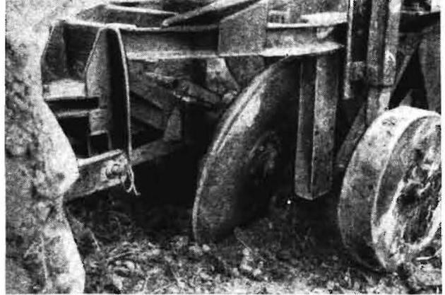
Bild 1. Rodewerkzeuge der Möhrenerntemaschine
