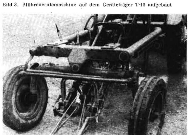
Bild 3. Möhrenerntemaschine auf dem Geräteträger T-16 aufgebaut
