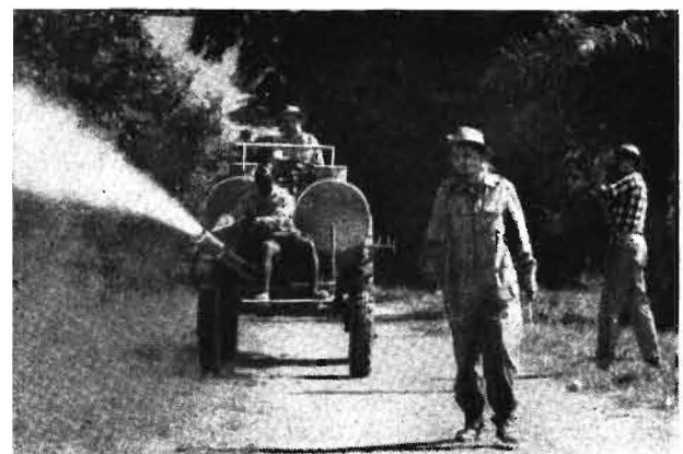
Bild 3. Anbau-Sprüh- und Stäubegerät S 293 mit Stäubedüsen zur Bekämpfung von Zitruschädlingen
