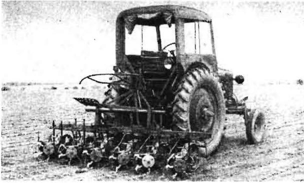
Bild 3. Rübenausdünnmaschine
