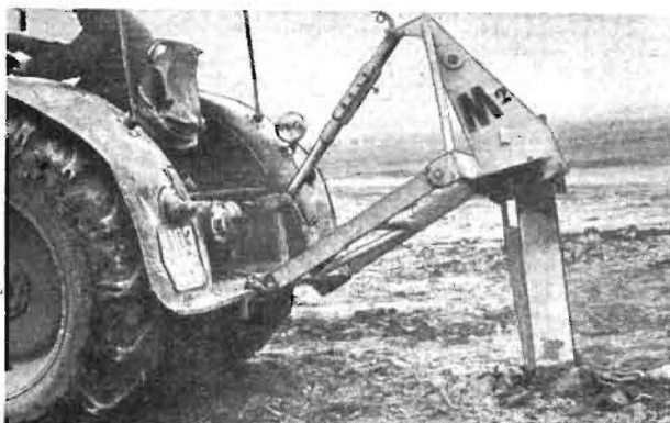
Bild 2. Maulwurfdränpflug leichter Ausführung, Anbautyp M 2 für Radschlepper ohne Hydraulik, vor dem Einziehen
