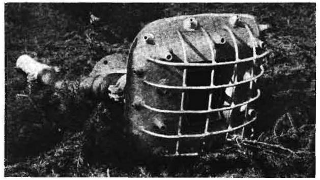
Bild 6. Spülkopf nach Körste zum Saugspülbagger „Berlin“.
