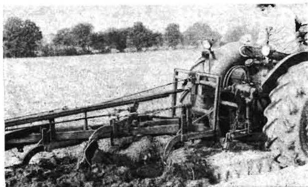
Bild 10. Bei dem 4furchigen Versuchspflug mit automatischer Steinsicherung weicht der betreffende Körper vor einem Bodenhindernis aus und zieht sich anschließend von selbst wieder ein
