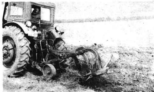
Bild 9. Beim Auftreffen auf einen Stein kann der Anbaupflug um die Tragachse nach oben ausweichen, durch Zwischenplatten wurde die Tragachse um 10 cm tiefer gelegt
