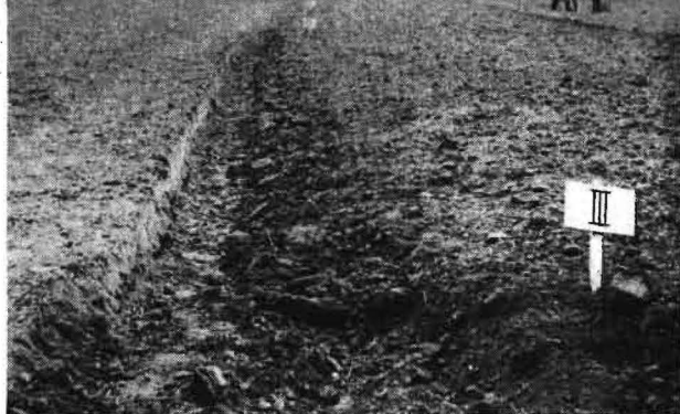
Bild 2. Der Körper 30 Z bei hoher v_f (12 km/h), großer Seitentransport und Entmischung des Bodens (Grobaggregate nahe bei der Furche, Feinboden weiter entfernt, obenauf liegend), Oberfläche eingeebnet (Furchenbild sofort nach dem Pflügen)
