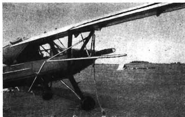
Bild 5. L-60 mit neuentwickelter Sprühanlage, außenverlegte Rohre mit vier Zentraldüsen
