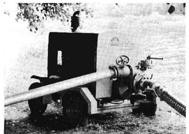
Bild 1. Pumpenaggregat AGRO 3/M 2 — TAM 4 zur jugoslawischen Beregnungsanlage
