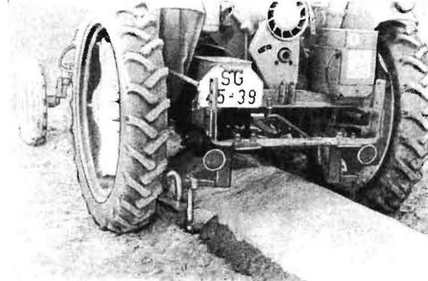
gelegt. Da der Bügelabstand 500 mm beträgt, muß ein Getriebe mit einer Übersetzung von 1 : 5 an die Zapfwelle angeschlossen werden, damit nach jeder Umdrehung bzw. nach 0,5 m ein Steuerimpuls durch den Kontaktgeber an den Steuermagnet für die Hydraulikanlage der Bügelsetzvorrichtungen gegeben werden kann.
