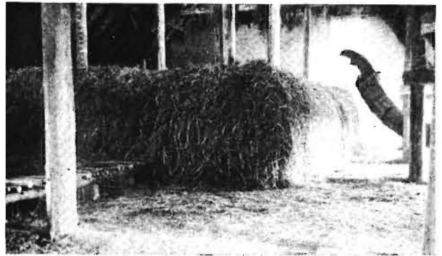
Bild 5 Richtige Stellung des Ausblaskopfes der Förder-Gebläse- leitung 630 mm Ø. Im Vordergrund ist die Rostfläche einer weiteren Heu- belüftungsanlage zu erkennen
