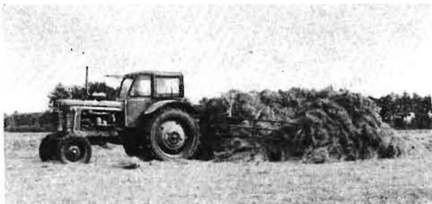
Bild 3. Schiebesammler mit Seitengreifern beim Zusammenschieben von Heuschwadern
