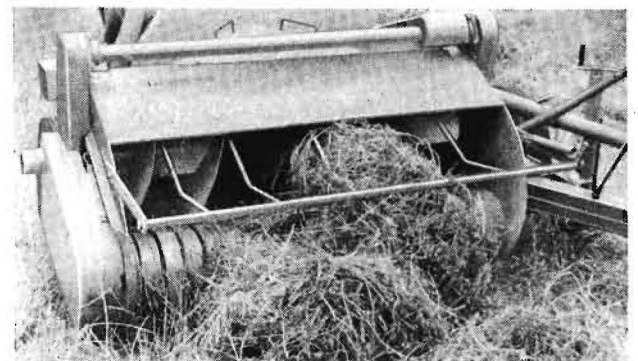
Bild 3. Vom Flügelrad des ASG 150/63 strangartig zusammengedrehtes Halbheuschwad. Das Erntegut wurde vom Schwad abgerissen und in die Zinken des Rückhalterechens eingedreht
