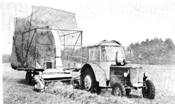
Bild 2. Bergung von Wiesenheu mit dem Aufsammelschneidgebälge ASG 150/63
