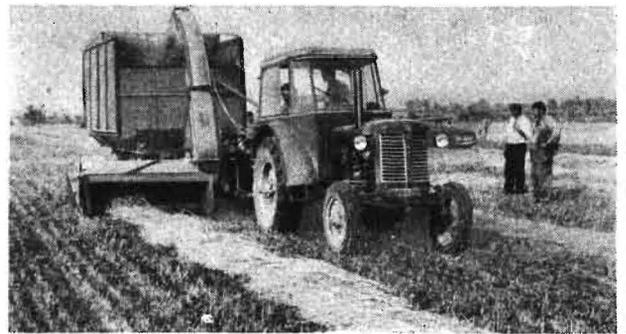
Bild 2. Kombiniertes Feldhäcksler SPK2-160 (CSSR) mit vorgebauter Aufnahmevorrichtung bei der Bergung von Gerste aus dem Schwad
