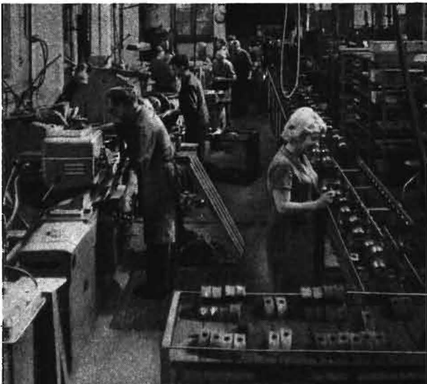
Bild 2. Fließreihe zur Bearbeitung eines Kurbeltriebes (Kurbelwelle schleifen, Pleuel bohren, Kolben und Pleuel auswiegen und paaren, kpl. Kurbeltrieb auswuchten) im MTS-Reparaturwerk Halle/Saale; Kapazität 30 St./Schicht
