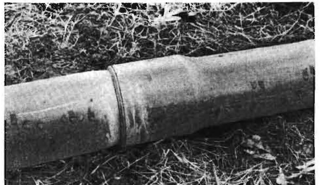
Bild 3. Klebemuffenverbindung mit Schweißbraupe
