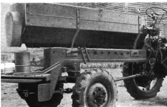
▲ Bild 1 Selbstgefertigter Schleuderdüngerstreuer am RS 09
