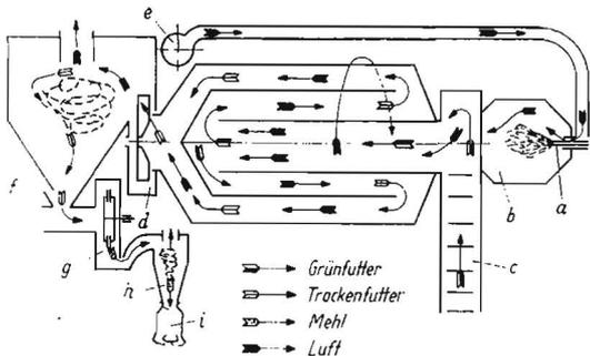
Bild 2. Technologie des Trocknens und Mahlens. a Dieselölinjektor, b Brennkammer, c Förderband, d Exhaustor, e Luftventilator, f Zyklon, g Hammermühle, h Mühlenszyklon, i Abfallsack
