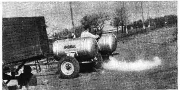
Bild 2. Weißer Dampfaustritt an den Düngekesselwagen zeigt die Beendigung des Füllvorganges an
