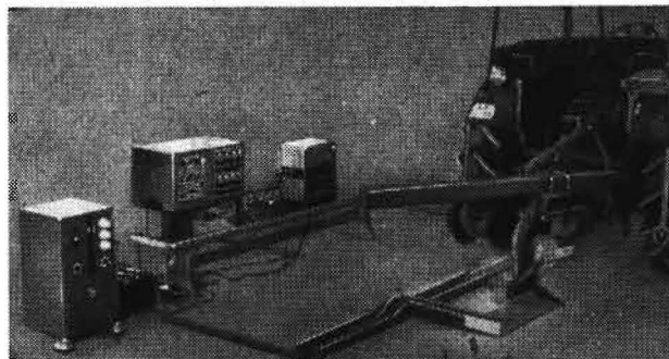
Bild 3 Versuchseinrichtung zur Messung der waagerechten dynamischen Auslösekräfte
