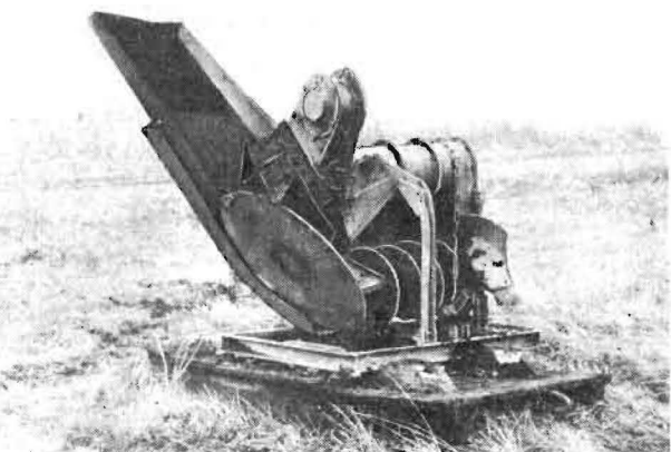
Bild 3. Anbauarbeitsgerät Grabenreiniger mit Transportstützbock, aufgesetzt auf eine Kufenschleppe
