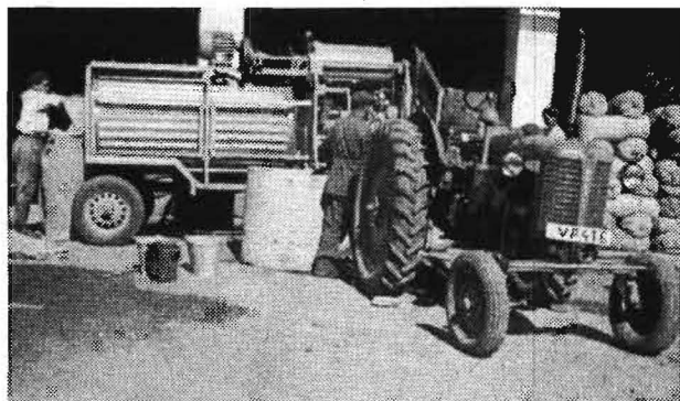
Bild 2. Fahrbare Beizanlage PC
