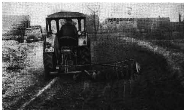
Bild 2. Als Abdeckgerät umgebaute Scheibenegge (LPG Melkow-Jessow, Krs. Boitzenburg)
