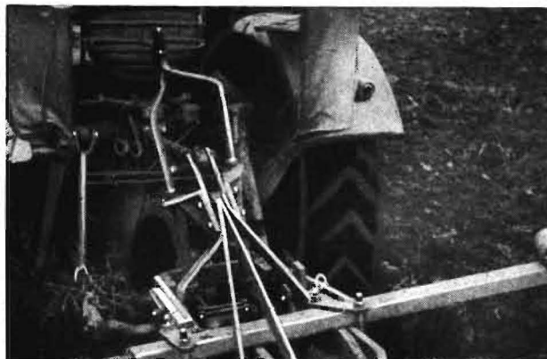
Bild 4. Ungünstige Stellung des oberen Lenkers (Zetor und Anbaupflug B 110 mit verbogener Koppelstange)
