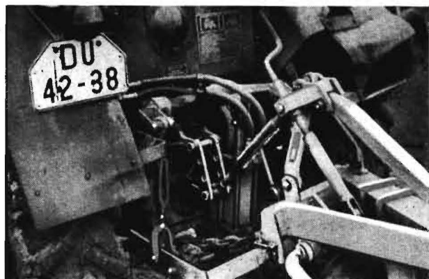
Bild 3. Günstige Stellung des oberen Lenkers (Belarus und Anbauschleibenpflug B 137/3)
