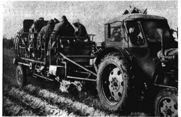
Bild 1. E 675/1 arbeitet auch bei 75 cm Reihenabstand auf mittleren bis bindigen Böden zufriedenstellend
