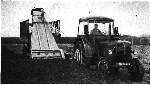
Bild 2. Schlegelhäcksler E 069 bei der Ernte von Grüngut
