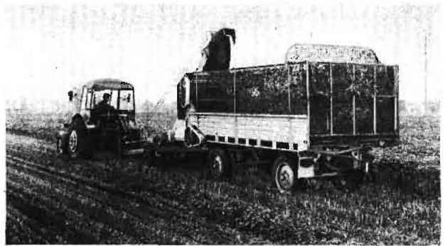
Bild 3. Futtermittelverteilungswagen F 931 bei der Grünguternte in Verbindung mit dem E 069
