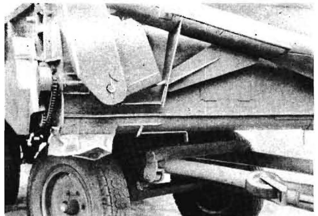
Bild 4. Entladen des Mischfutters über die Querförderschnecke
