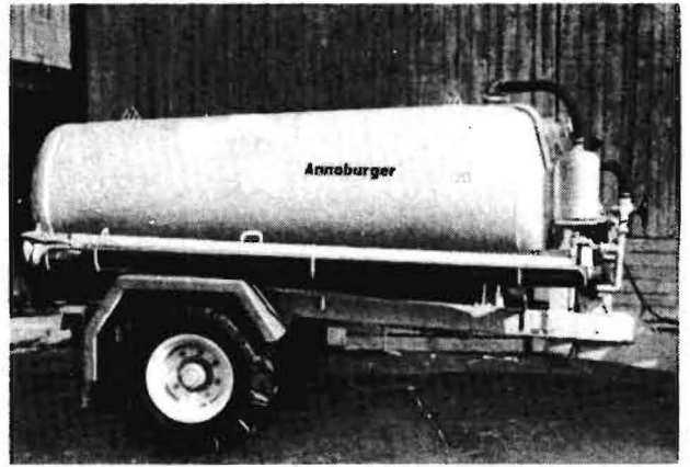
Bild 4. Funktionsmuster eines Flüssigmist-Fahrzeuges nach dem Prinzip C aus dem VEB Fahrzeugwerke Annaburg
