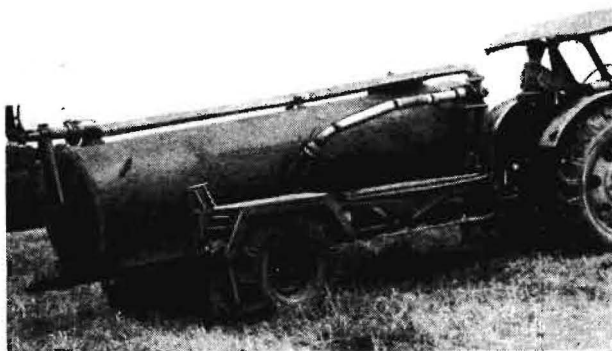
Bild 7. Funktionsmuster eines Flüssigmist-Tankwagens nach dem Prinzip D aus dem Institut für Landtechnik der Hochschule für LPG Meißen
