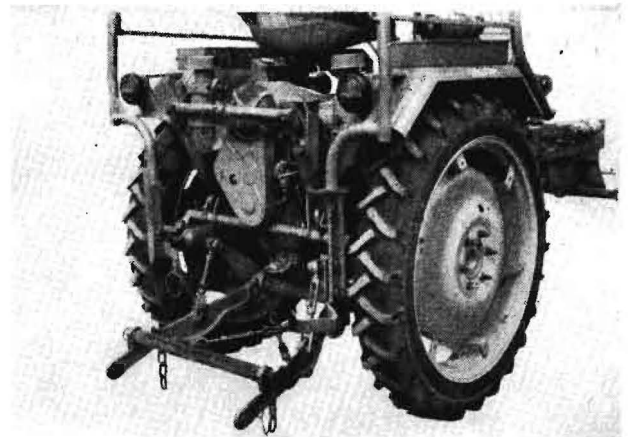
Bild 3. Heckansicht des RS 09/124 mit Motor 4 VD 8, Geräteschiene und Dreipunktaufhängung
