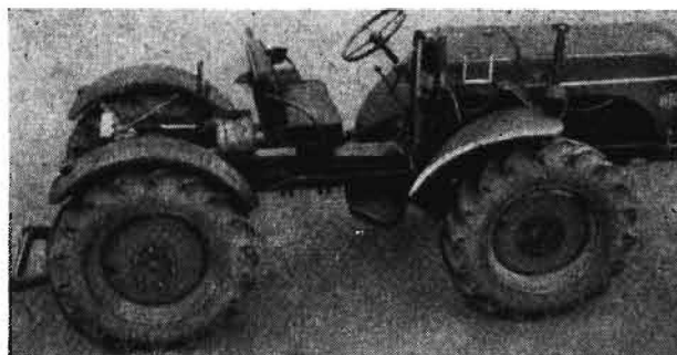
Bild 3. Allradgetriebener Traktor „BTG“ (Bayerische Traktorengesellschaft) ohne zusätzliche Achsbelastung. Die Hinterräder besitzen Achsschenkellenkung, die durch eine hinter dem Fahrersitz liegende Handkurbel betätigt wird.
